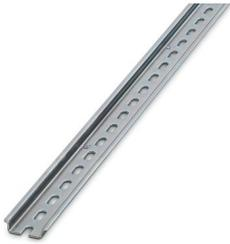
Carril simétrico perforado, según EN 60715, material: Acero, Galvanizado, pasivado blanco, Perfil estándar, color: plateado, Variante de embalaje con 25 unidades (50 m)
