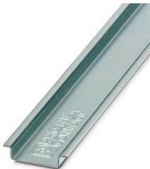
Carril simétrico sin perforar, según EN 60715, material: Acero, Galvanizado, pasivado blanco, Perfil estándar, color: plateado, Variante de embalaje con 10 unidades (20 m)
