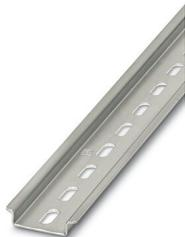
Carril simétrico perforado, según EN 60715, material: Acero, galvanizado, pasivado de capa gruesa, Perfil estándar, color: plata, Variante de embalaje con 25 unidades (50 m)
